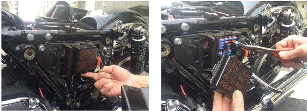
②シート下のフィンがあり、大きなコネクタが接続されているECMを確認。ECMは樹脂のベースにはめ込まれているだけなので手でベースのツメ(下図1)を押さえて取外すことができる。赤いロックピンを抜く。(下図2)コネクタにある灰色レバーのロックがコネクタの中央にあるので指で押しながら(下図3)レバーをずらすとECMが分離できる。
