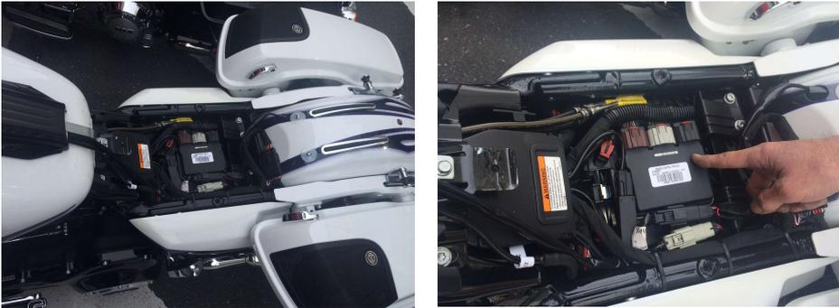
②ECMを固定するツメからはずす。各コネクターのツメは赤いロックで押せなくなっているので、親指の爪などで赤いロックをスライドさせる。
