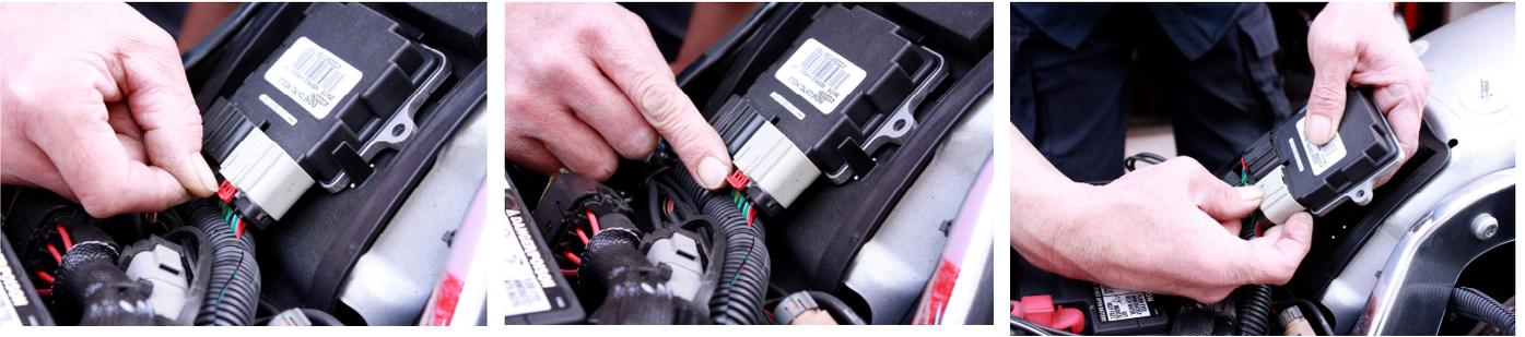
④電子スロットル車は茶色、灰色、黒の3つのコンネクターが繋がっているECMを確認。各コンネクターのツメは赤いロックで押せなくなっているのので、親指の爪などで
