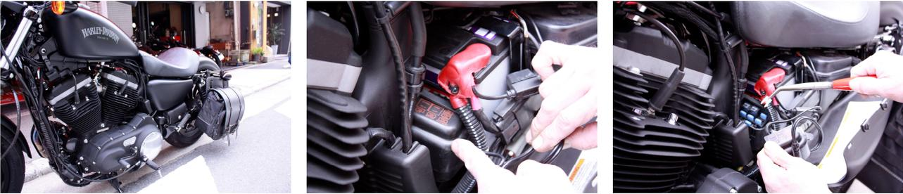
②エンジン後ろ側、黒い樹脂ケース（下図1）、車体左寄りにヘキサゴンボルト一本を確認。ボルトを外しケースのフタをスライドさせながら取外し、灰色のコネクターが
