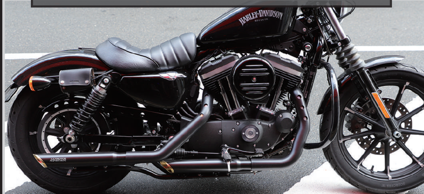
存在感を最大限に抑えたマフラー、音はベビーブラス76と同様の重低音
