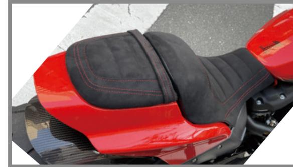
高級感溢れるスウェード製、シートポジションが前へ約5cm移動してハンドル・ブレーキ操作がしやすくなり、座面を低く細身にして足つきを向上
