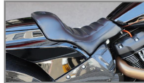
滑らかにスマートなデザイン、シートポジションが前へ約5cm移動してハンドル・ブレーキ操作がしやすくなり、座面を低く細身にして足つきを向上
