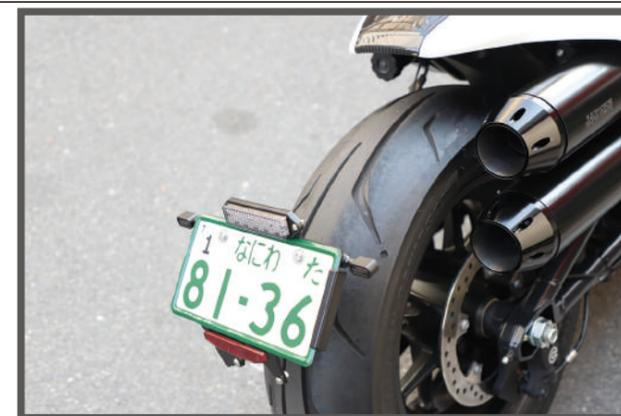
完全ボルトオン設計。配線の加工も必要なく取付が可能。純正より高い位置にマウントをすることでスッキリとしたシルエットになります
