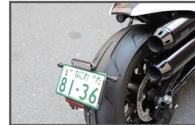
完全ボルトオン設計。配線の加工も必要なく取付が可能。純正より高い位置にマウントをすることでスッキリとしたシルエットになります
